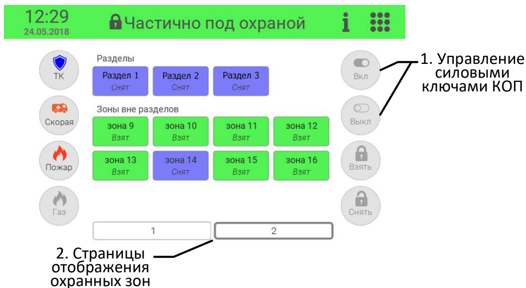
Рисунок 4 – Органы управления в режиме «Раздельное управление»
